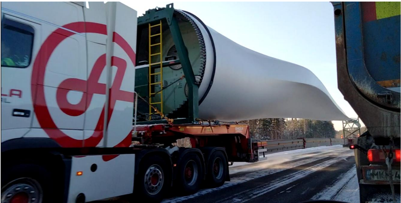
Bild 10: Landsvägstransport av rotorblad till vindkraftverk 22.2.2023 ©T. Järvinen
