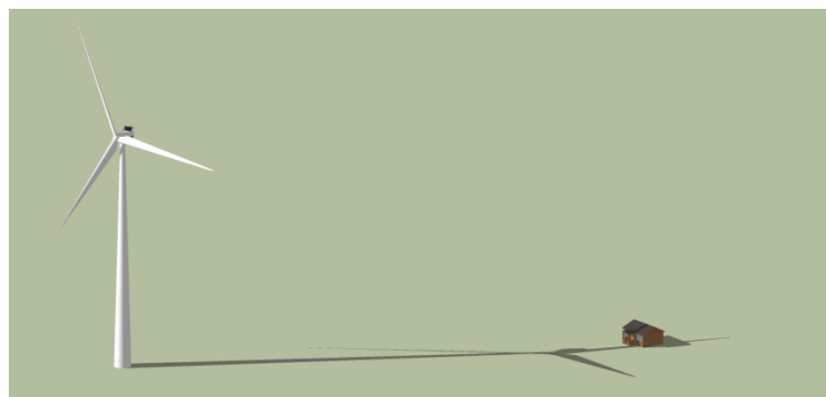
Figur 1. Skuggeffekter bildas vid soligt och klart väder då vindkraftverket snurrar mellan solen och observationspunkten.
